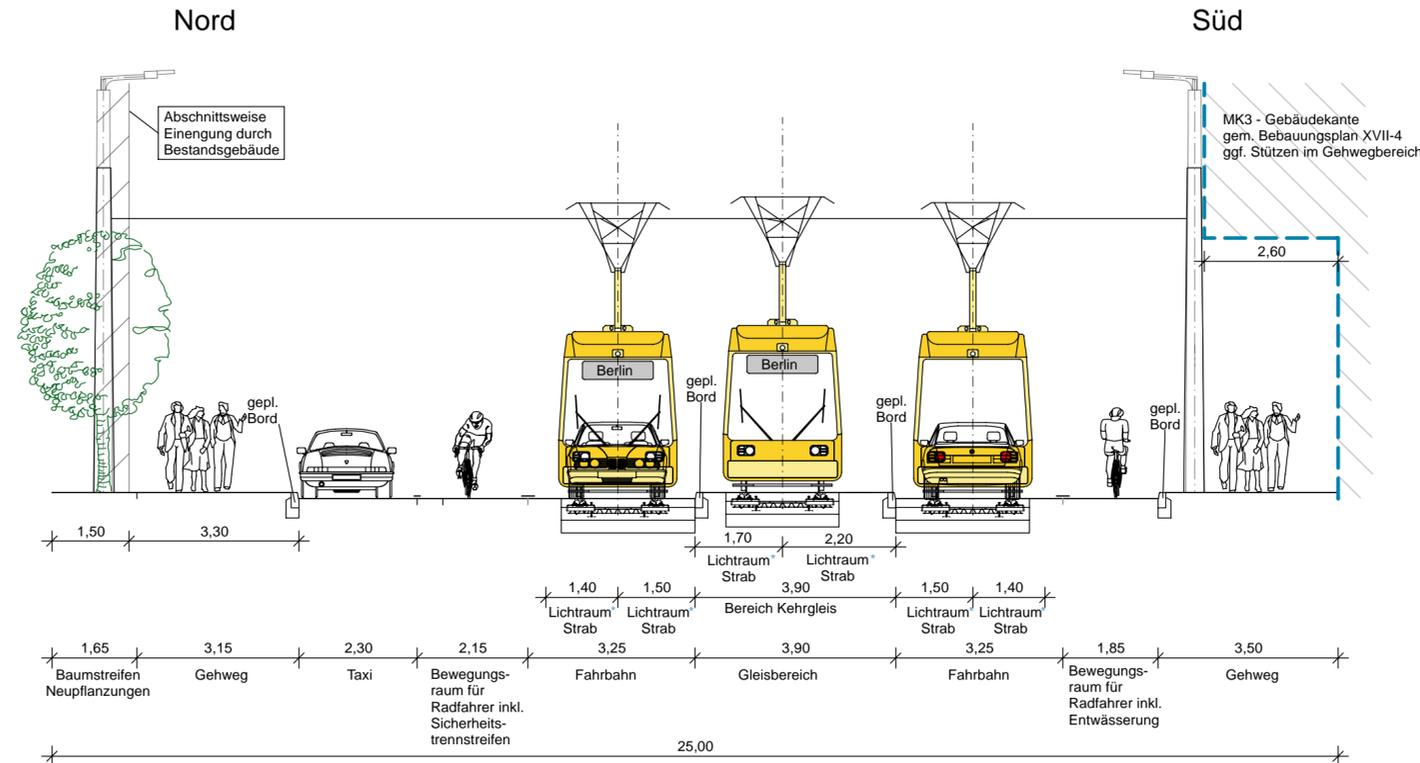
\* gemäß Regellichraum zwischen 2000 mm und 2500 mm über Schienenoberkante durch Spiegel um 150 mm erweitert
