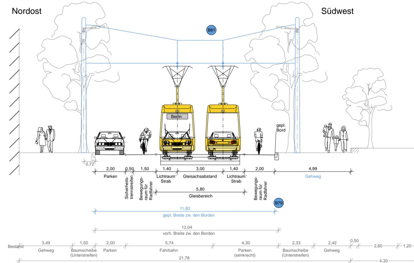
gemäß Regellichraum zwischen 2000 mm und 2500 mm über Schienenoberkante durch Spiegel um 150 mm erweitert
