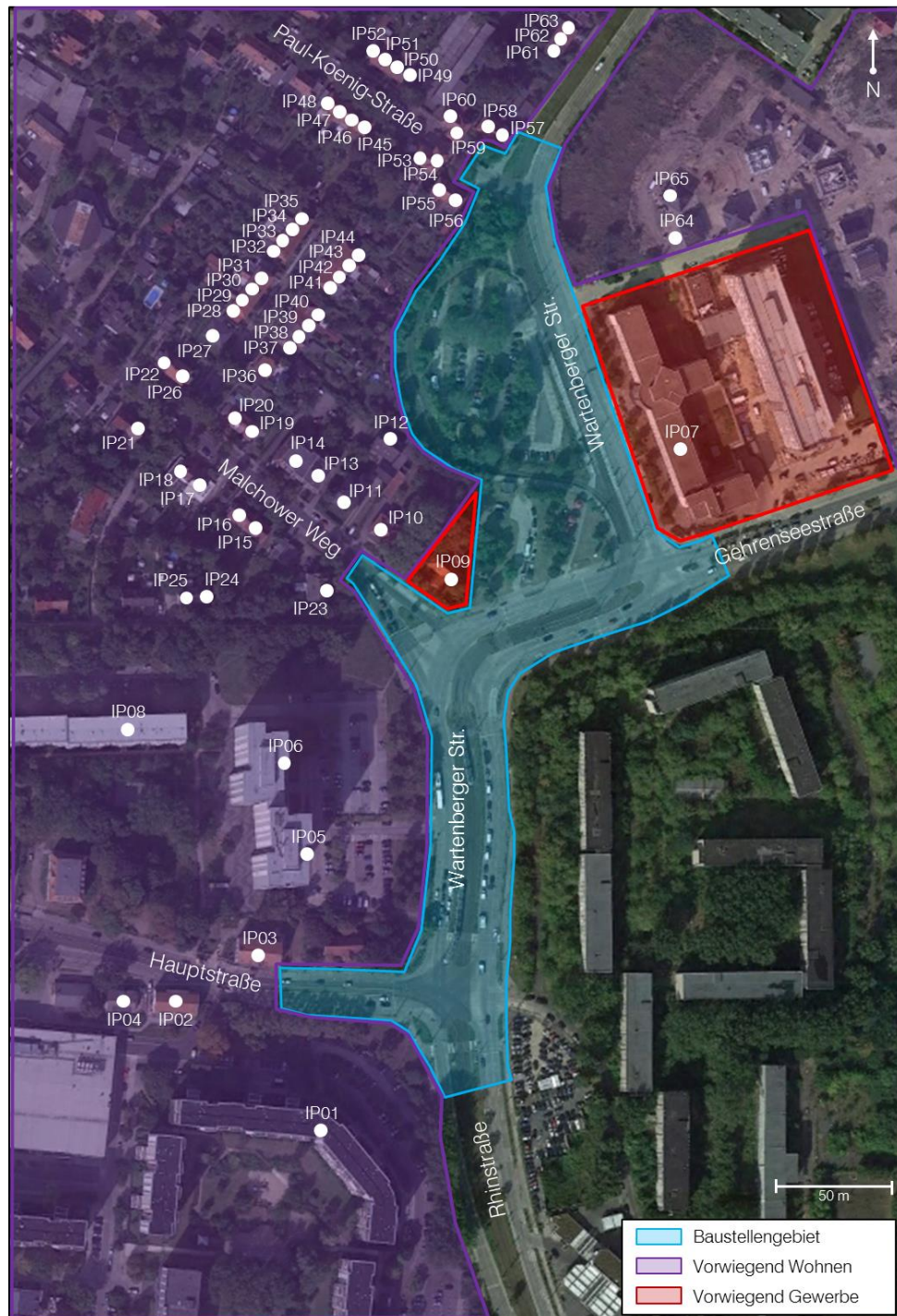
Abb. 3.1: Baustellengebiet und Einstufung der Umgebung gem. den Kategorien der AVV Baulärm sowie betrachtete Immissionsorte
