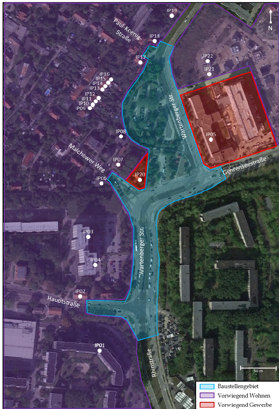
Abb. 3.1: Baustellengebiet und Einstufung der Umgebung gem. den Kategorien der AWW Baulärm sowie betrachtete Immissionsorte
