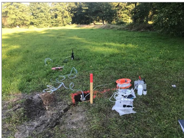
Abbildung 1: Aufbau Probenahme Grundwasser
