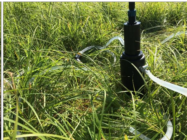
Abbildung 8: Aufbau Probenahme Grundwasser
