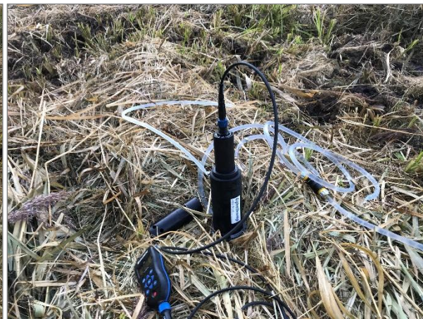
Abbildung 20: Aufbau Probenahme Grundwasser
