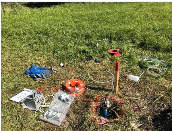
Abbildung 7.1: Probenahme an temporären Grundwasserpegel (hier Wehr 45)
