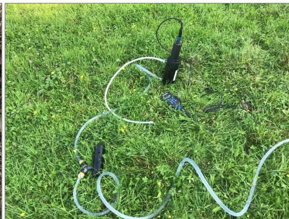
Abbildung 7.4: Ermittlung Vorort-Parameter mittels Multiparametersonde und Durchflussmesszelle
