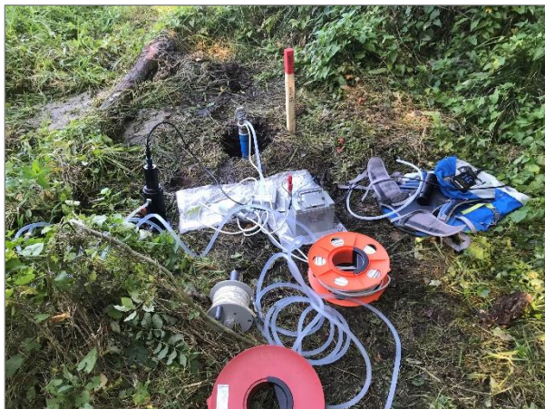
Abbildung 13: Aufbau Probenahme Grundwasser
