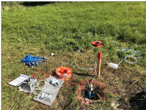
Abbildung 7: Aufbau Probenahme Grundwasser
