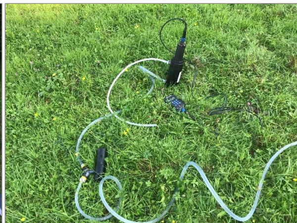
Abbildung 2: Aufbau Probenahme Grundwasser
