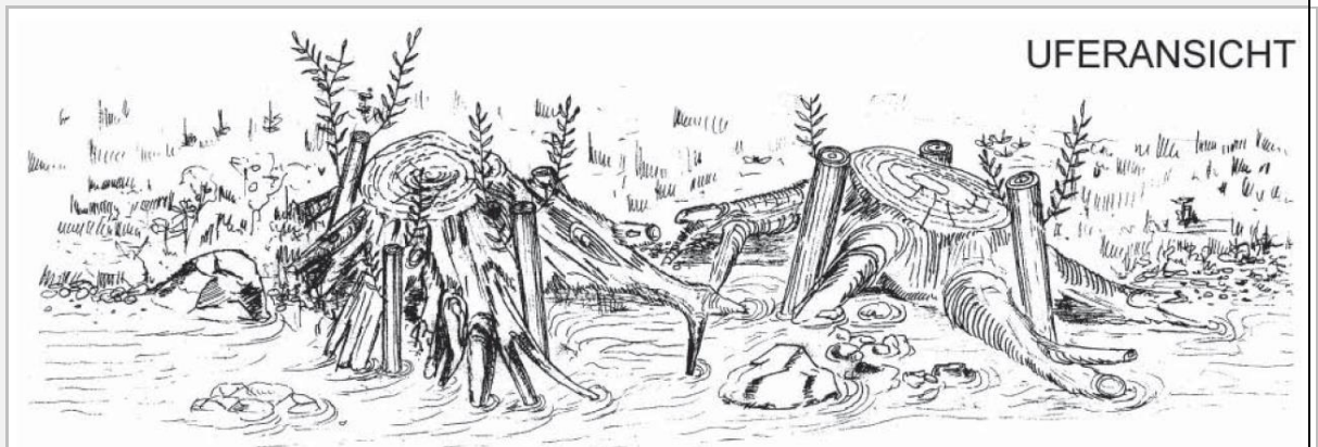
Abbildung 9-9: Schematische Darstellung eines eingebauten Wurzelstocks (BMLFUW & ÖWAV 2006)
