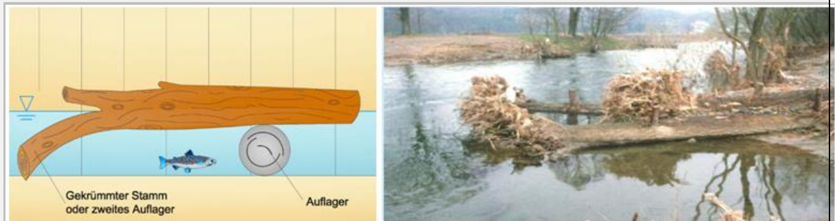
Abbildung 9-8: Darstellung eines Einzelstammes (GEBLER 2005)
