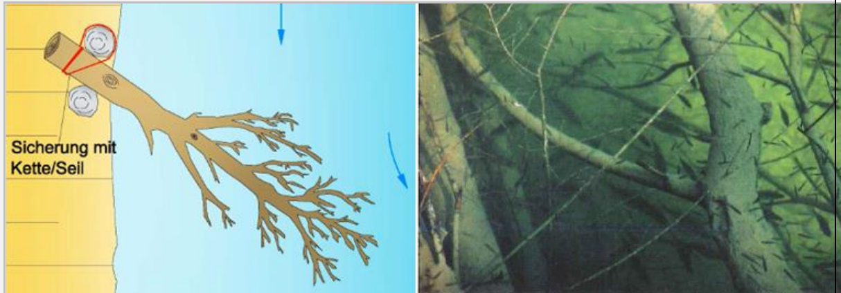
Abbildung 9-7: Darstellung eines Raubaumes als Ruheplatz für Jungfische (GEBLER 2005)
