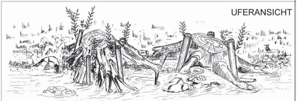
Abbildung 9-9: Schematische Darstellung eines eingebauten Wurzeltellers (BMLFUW & ÖWAV 2006)
