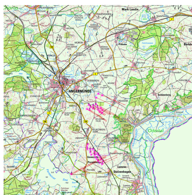
Abbildung 10: Darstellung der verbleibenden Sichteinschränkungen nach Kumulation aller betrachteter Sensoren vor Erweiterung des Windparks
