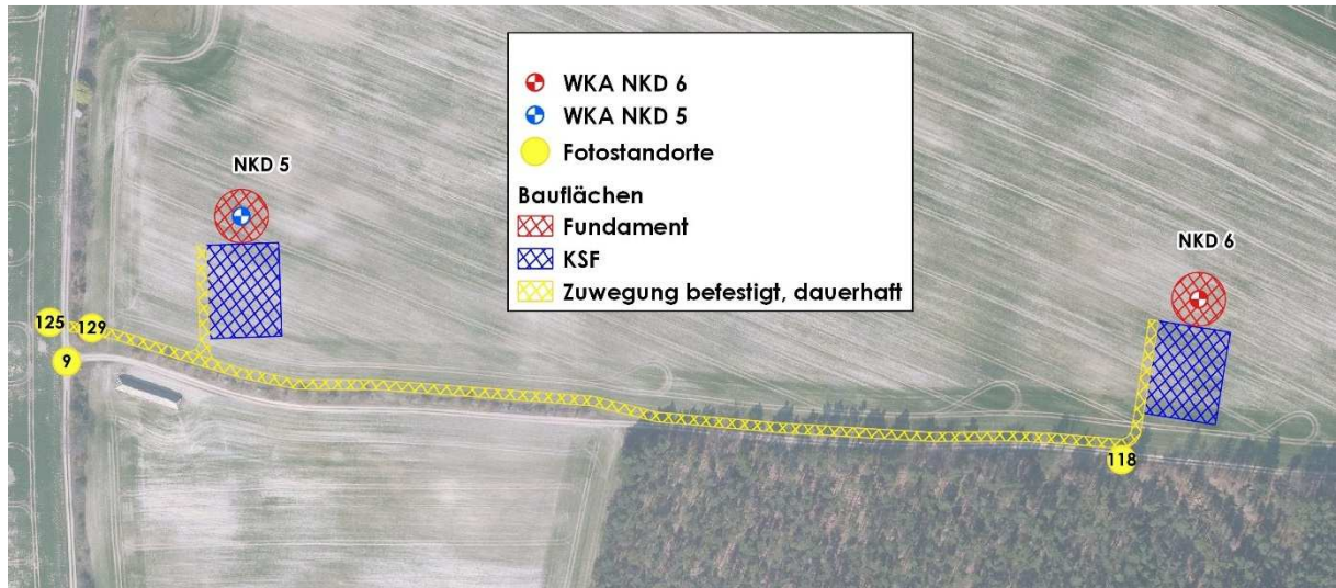
Abb. 10: Luftbild mit geplanten Bauflächen der WKA NKD 5 und 6 und Fotostandorte
