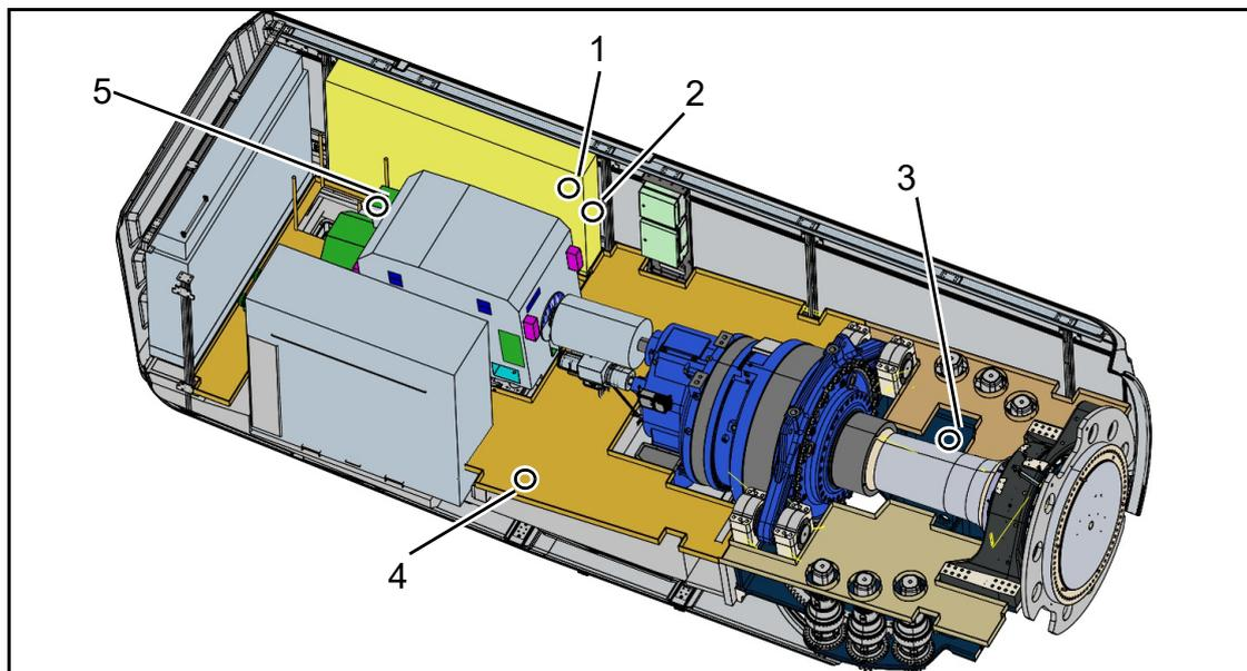
Abb. 16: Not-Halt-Schalter und Ausschalter Mittelspannung im Maschinenhaus
