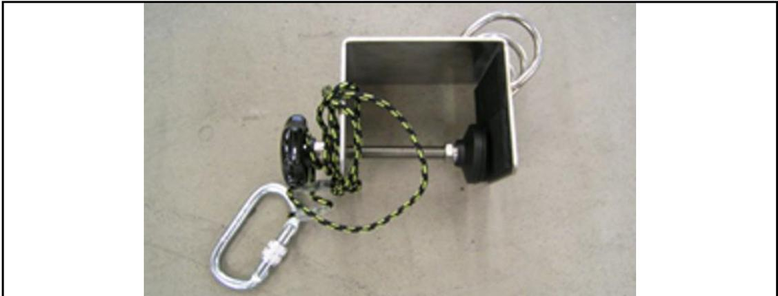
Abb. 26: U-förmiger Kantenschutz
