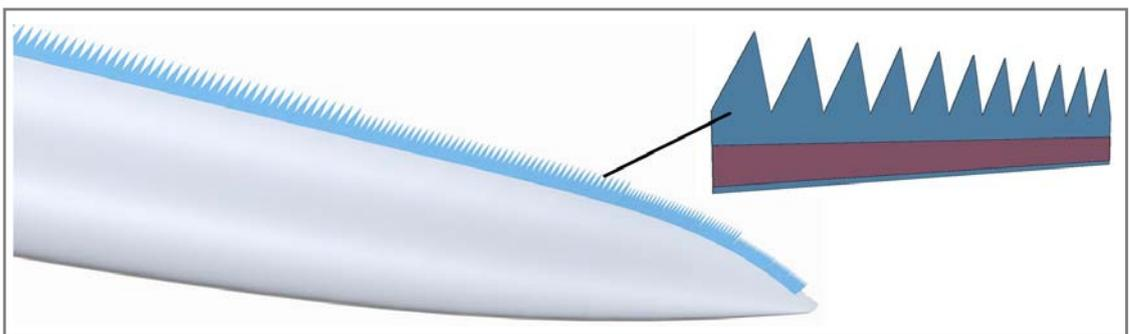
Abb. 3: *Blattspitze mit Serrations (Farbdarstellung der Serrations geändert)*
