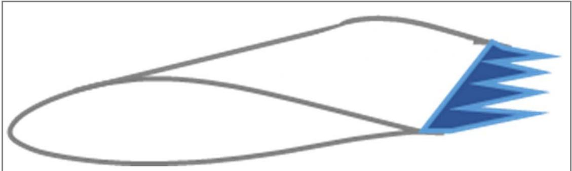
Abb. 2: *Prinzipskizze Serrations*
