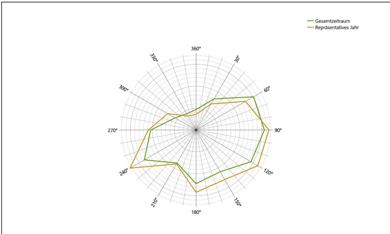
Abbildung 29: Vergleich der Richtungsverteilung von Nacht- und Schwachwinden für die ausgewählte Jahreszeitreihe mit dem Gesamtzeitraum
