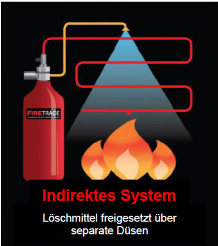
Abbildung 1: Darstellung des direkten und indirekten Löschmittelabgabesystems [U 10]
