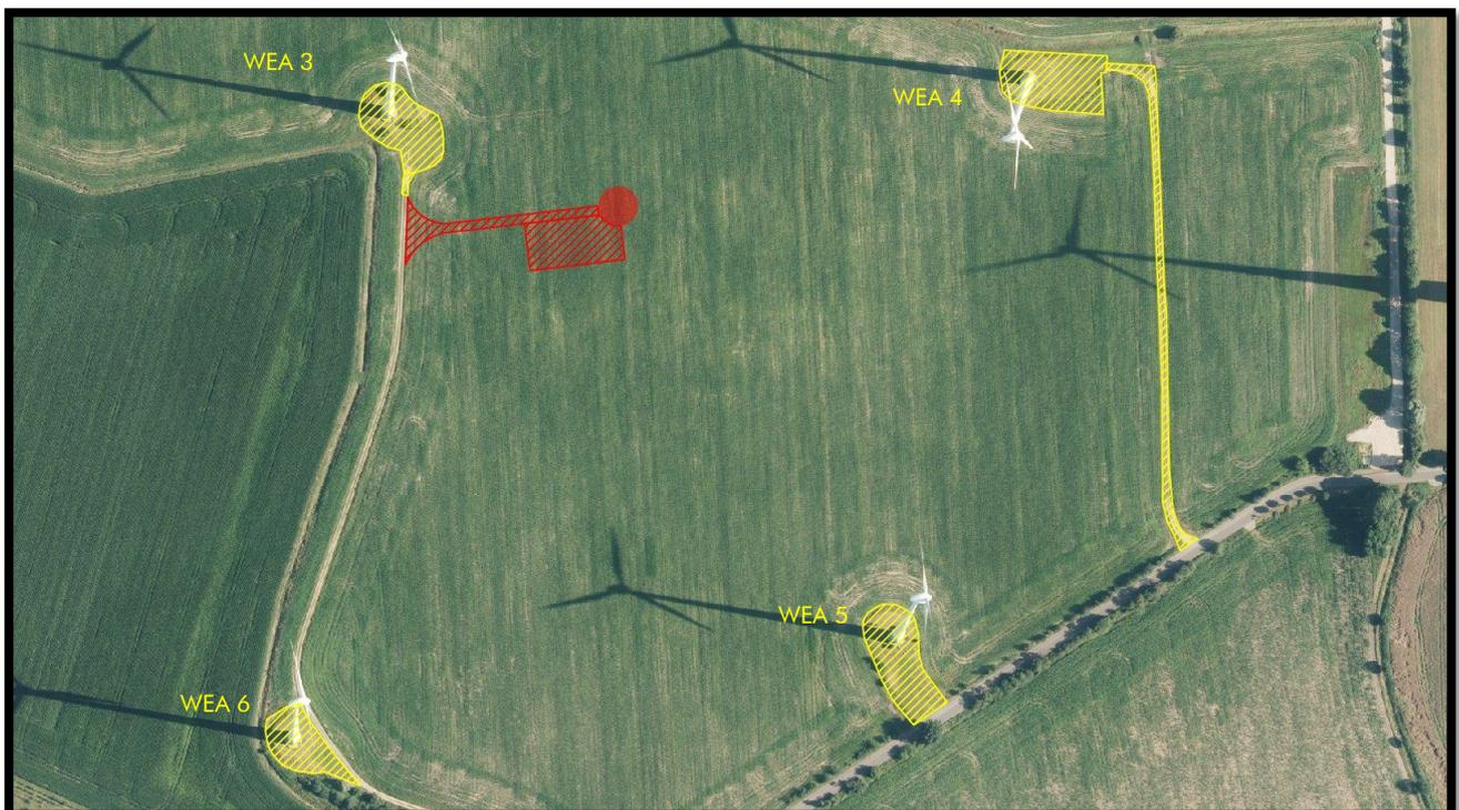
Abbildung 1 Flächeninanspruchnahme durch Fundament (roter Punkt), Zuwegung und Kranstellfläche (rote Linien) an der geplanten WEA und Rückbauflächen (gelbe Linien).
