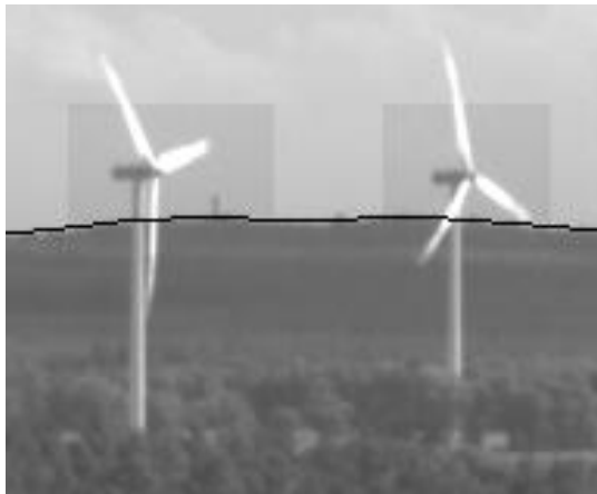
Abbildung 1: Automatisch generierte Ausschlussgebiete um Rotoren von WEA
