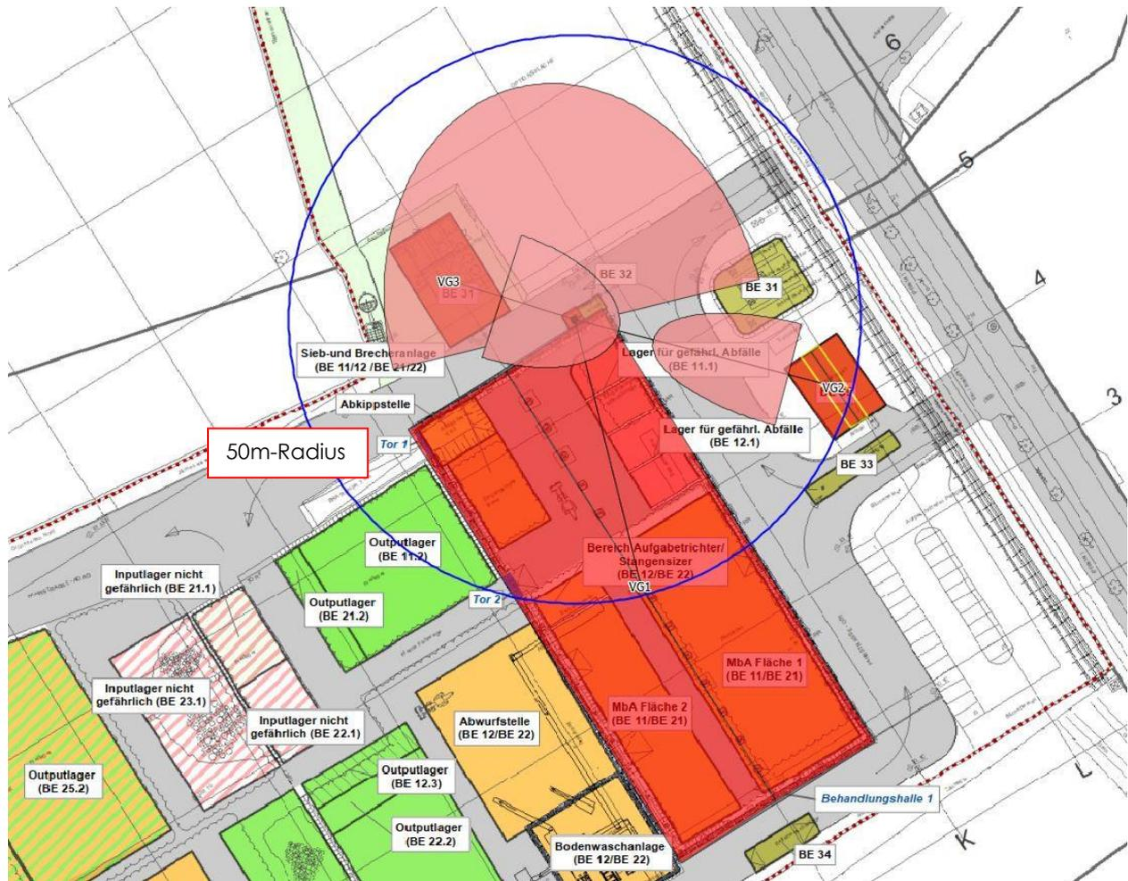
Abbildung 9: Einwirkungsbereich  $R=50$  des geplanten Schornsteins der Abluftreinigungsanlage
