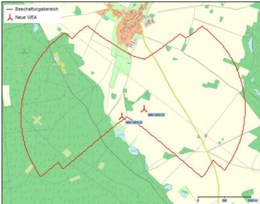
Abbildung 38: Beschattungsbereiche der neu geplanten WEA Hasenberg gem. Schattenwurfprognose (Abbildung 2 in RAMBOLL DEUTSCHLAND GMBH 2021)
