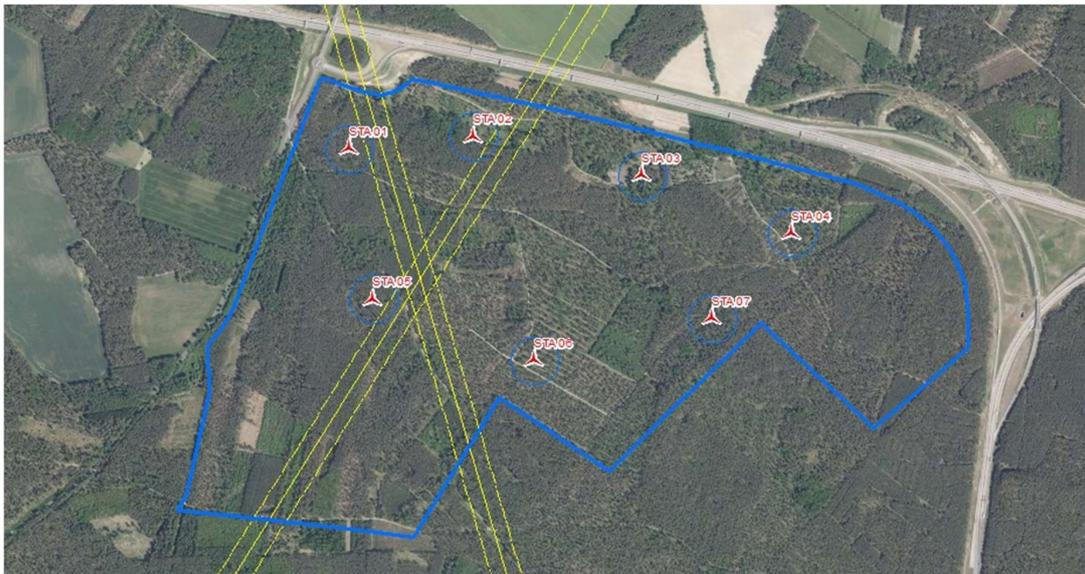
Abbildung 1: Übersichtskarte mit den geplanten Anlagenstandorten (rot), Richtfunkstrecke der Telekom mit 50m Abstandspuffer (gelb)
