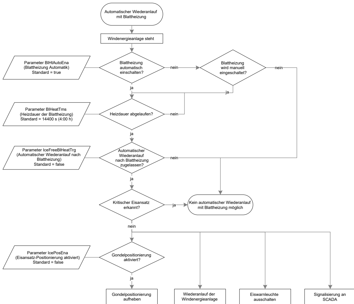
Abb. 3: Automatischer Wiederanlauf mit Blattheizung
