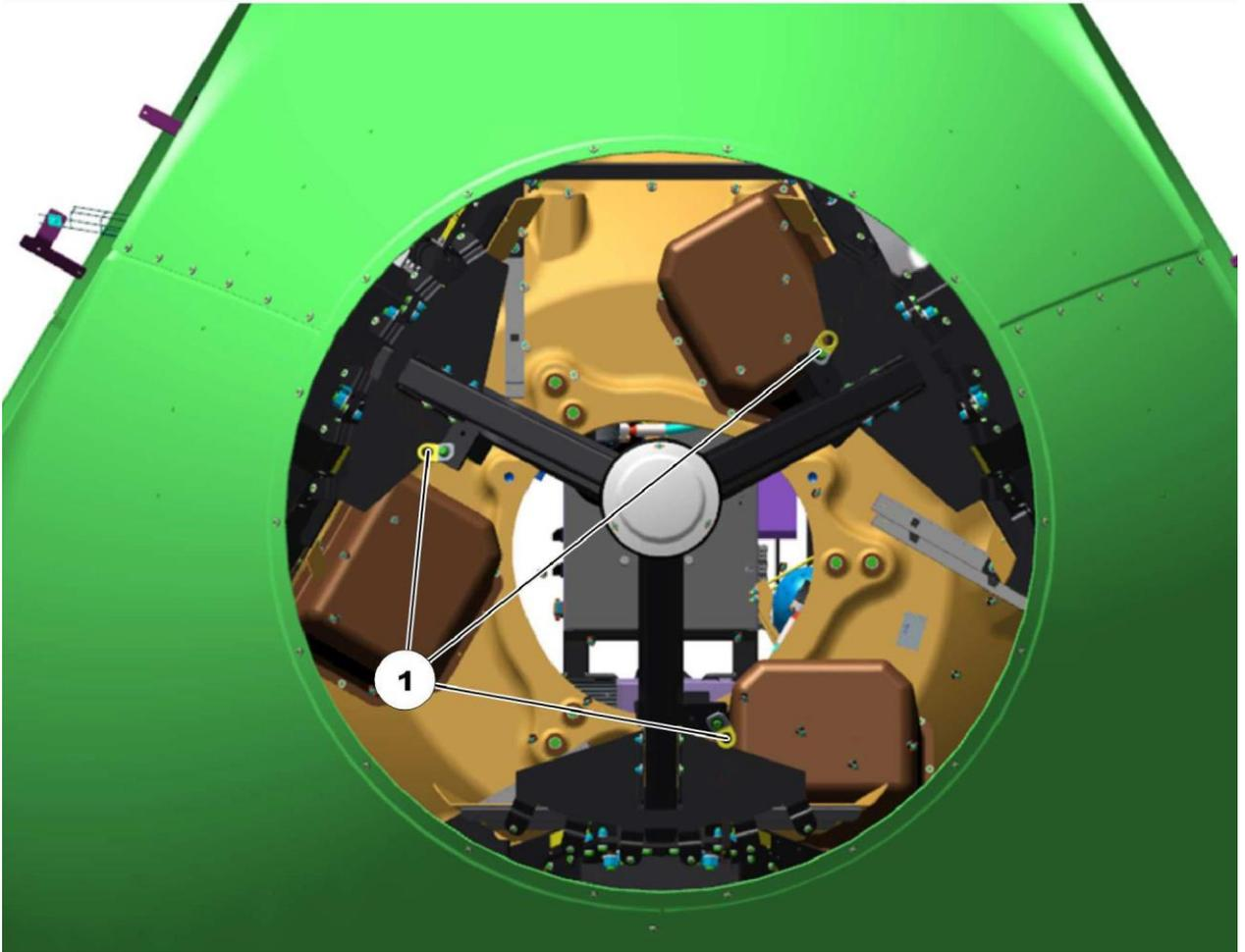
**Abbildung 7.14: Verankerungspunkte nahe der Luken in der Nabenabdeckung**
