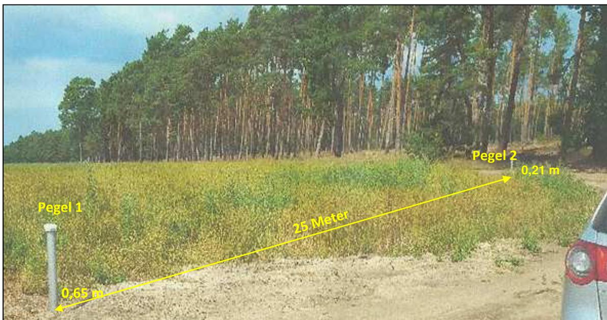
Abb.13 gemessene GW-Spiegelabsenkung unter RWSp. in beiden Pegeln bei 80,0 m<sup>3</sup>/h Förderleistung
