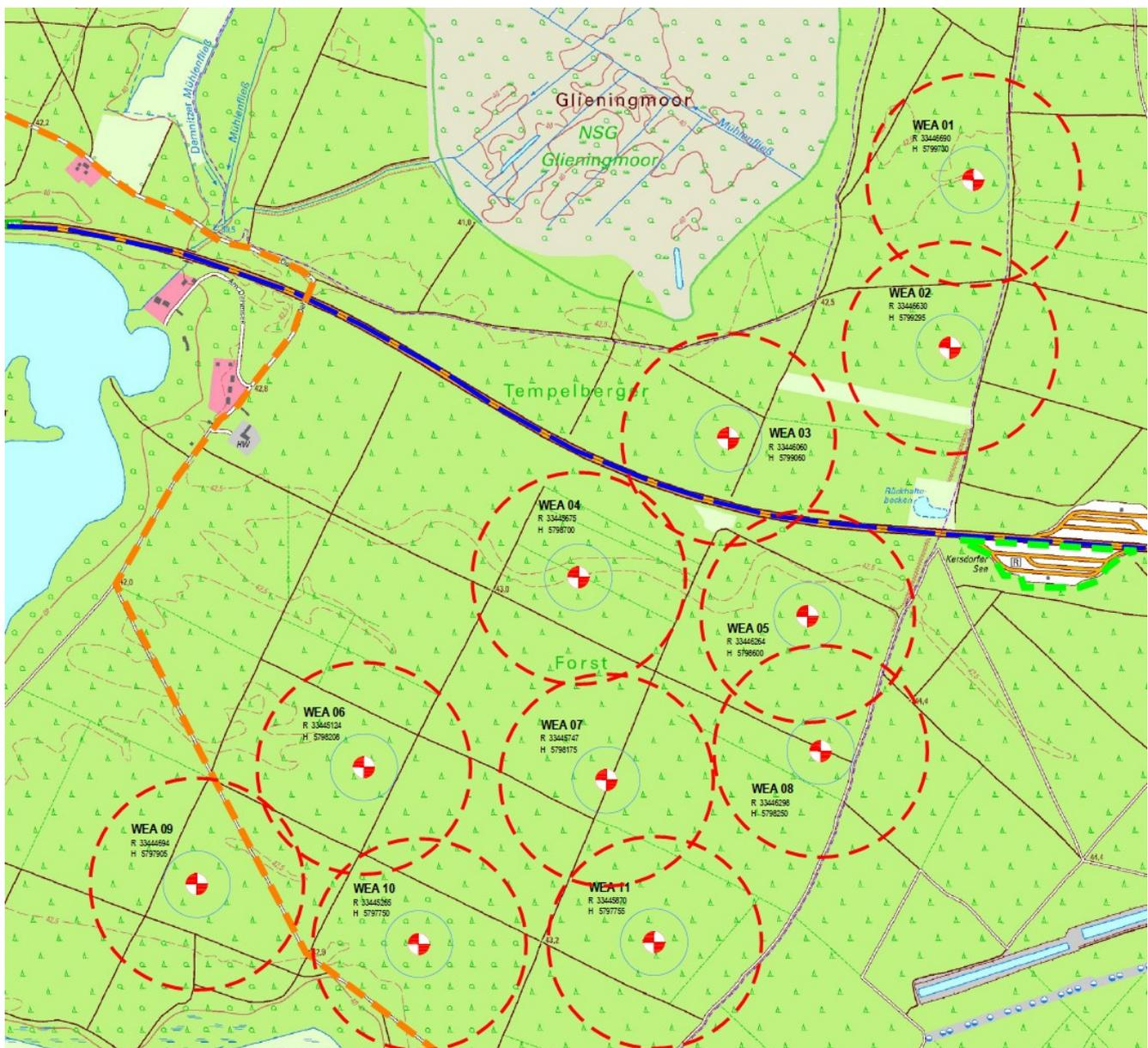
Abbildung 3: Gefährdungsradius – rot gestrichelt ( $v = 19,2 \text{ m/s}$ ).
