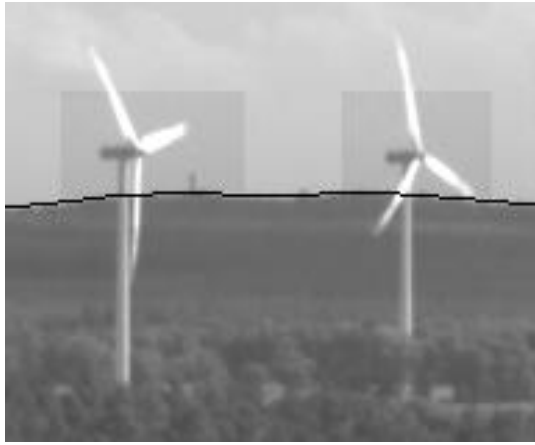
Abbildung 1: Automatisch generierte Ausschlussgebiete um Rotoren von WEA
