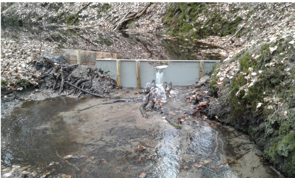
Abbildung 4-18: Messblende (MB 1) in der Kunster ca. 120 m abstromig der Kochquelle kurz nach dem Bau
