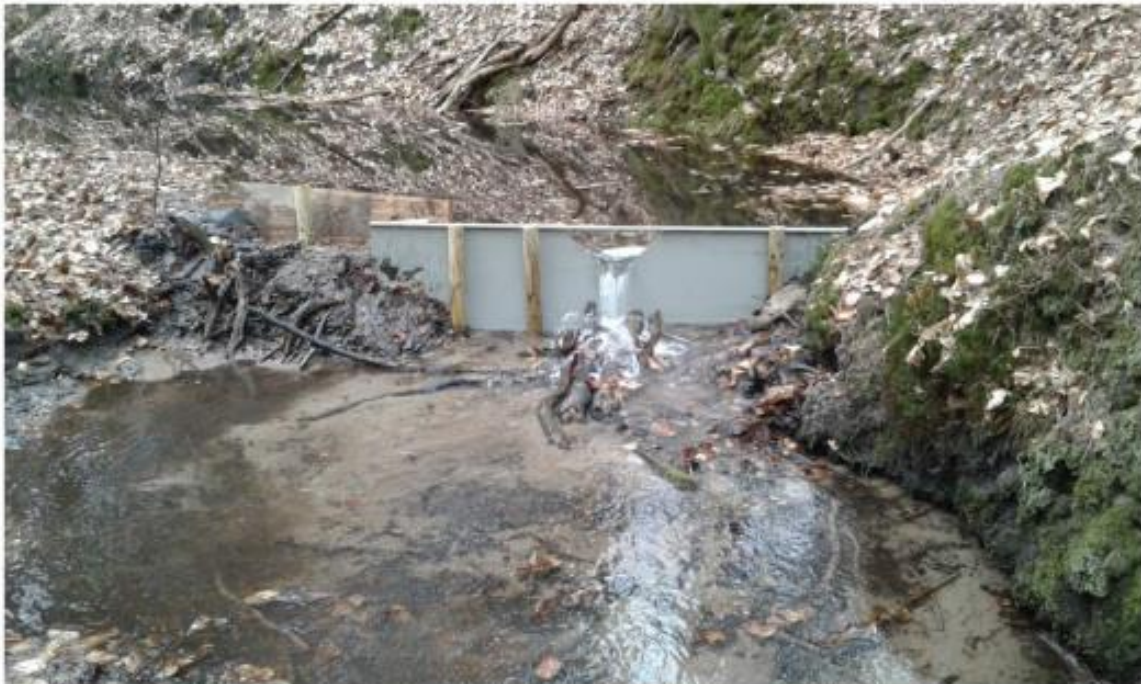
Abbildung 34: Messblende in der Kunster zur Abflussmessung (mehrfach zerstört)
