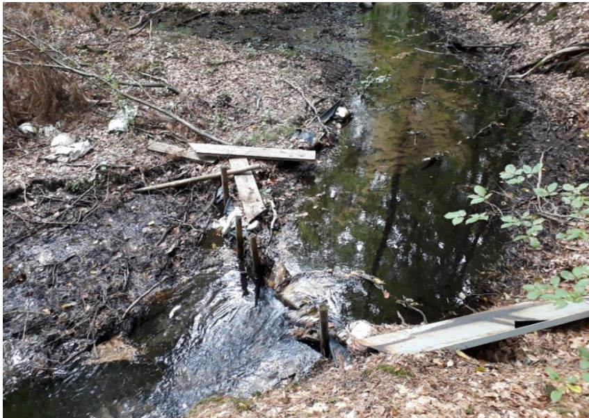
Abbildung 4-19: zerstörte Messblende (MB 1) in der Kunster (September 2018)
