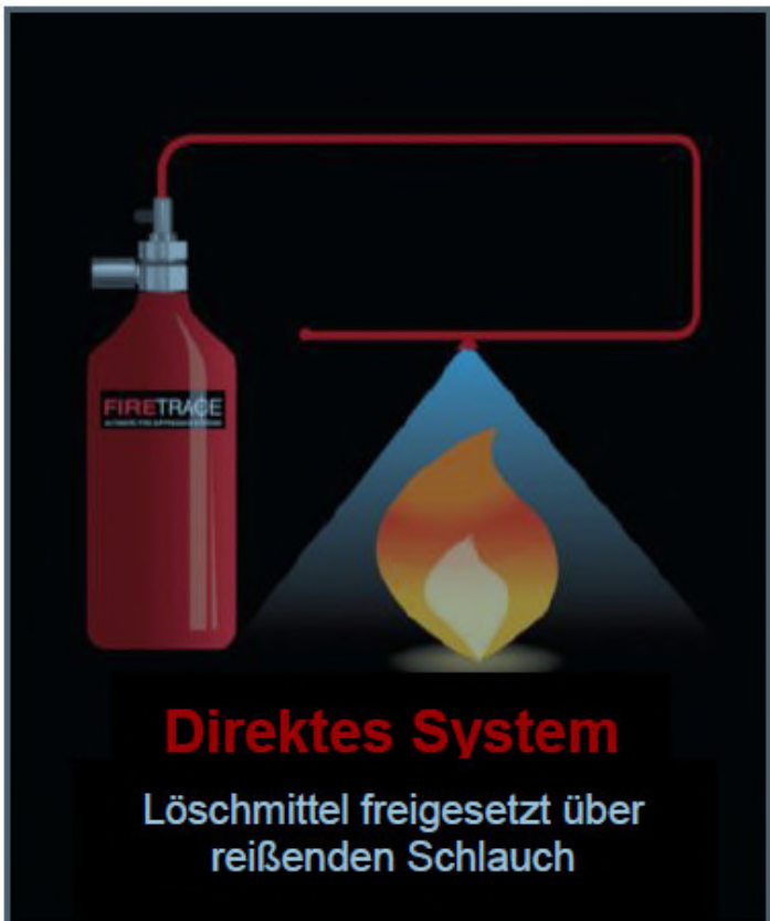
Abbildung 1: Darstellung des direkten und indirekten Löschmittelabgabesystems [U 10]
