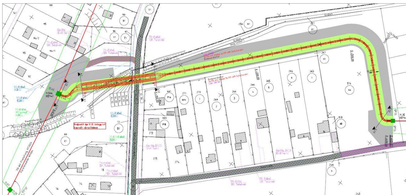
Abb. 2: Kabeltrasse mit Kabelschutzrohranlage zwischen Mast 58n und Mast 2En
