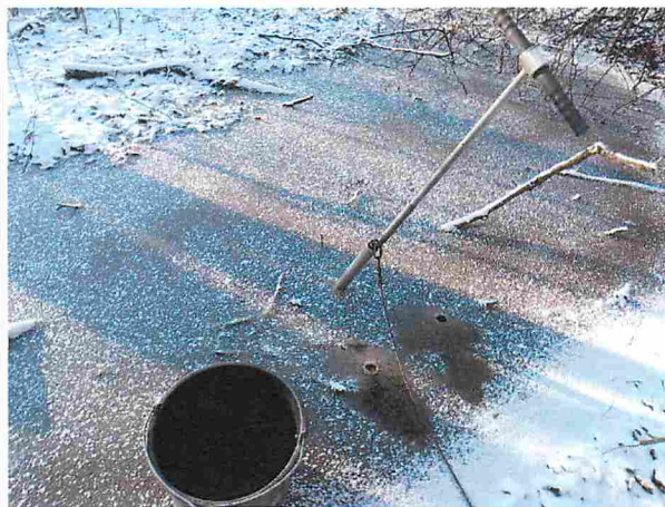
Die Probenahme erfolgte mittels am Gestänge geführter Unterdruckschlickpumpe.
