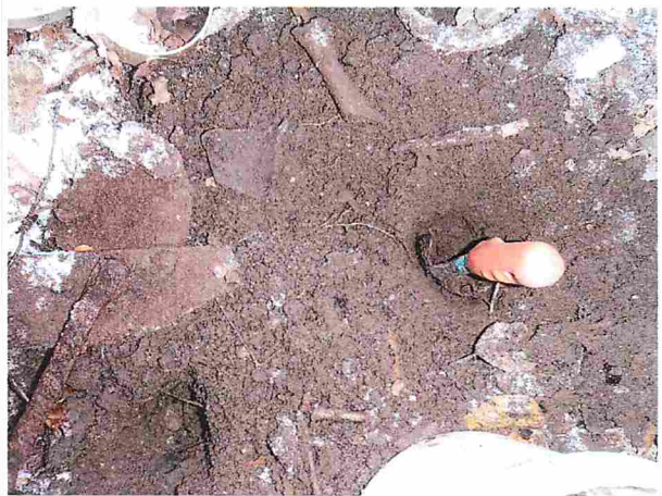
Die Probenahme erfolgte mittels Handspaten und Handschürfen von 30 cm Tiefe.
