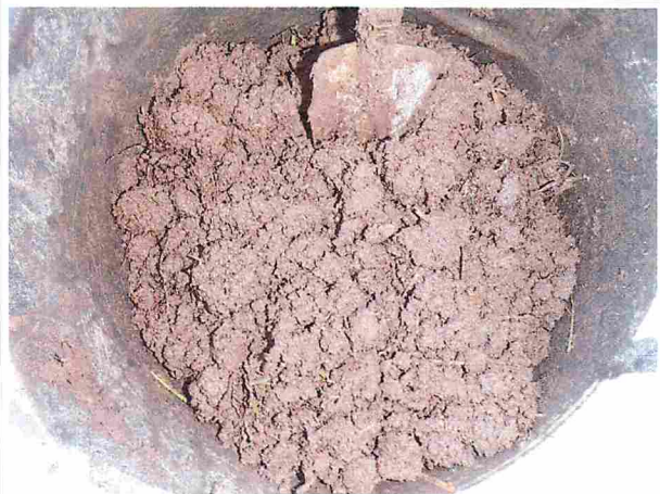
Herstellung der homogenisierten Mischprobe MP 6
