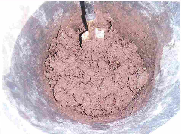
Herstellung der homogenisierten Mischprobe MP 4
