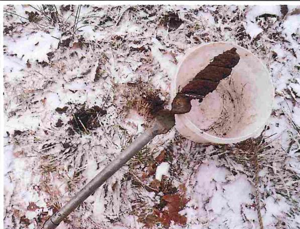
Die Probenahme erfolgte mittels am Gestänge geführtem Spiralbohrer.
