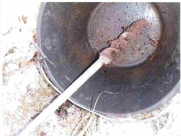
Die Probenahme erfolgte mittels am Gestänge geführten Spiralbohrer.
