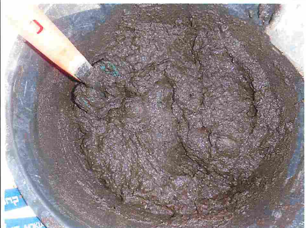
Herstellung der homogenisierten Mischprobe MP 5
