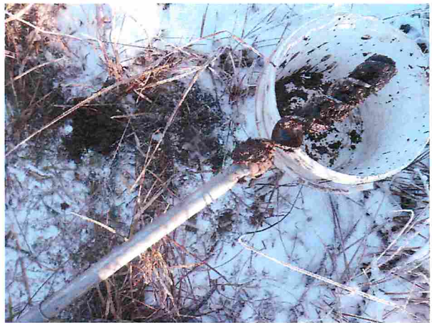
Die Probenahme erfolgte mittels am Gestänge geführtem Spiralbohrer.
