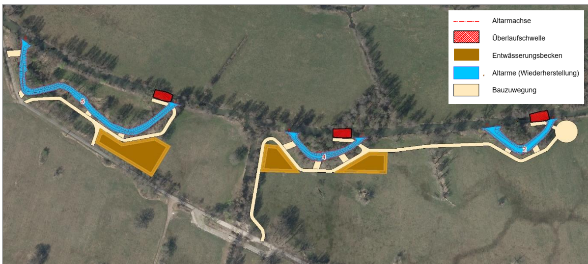
Abbildung 5.11: Bauzuwegungen und Entwässerungsbecken
