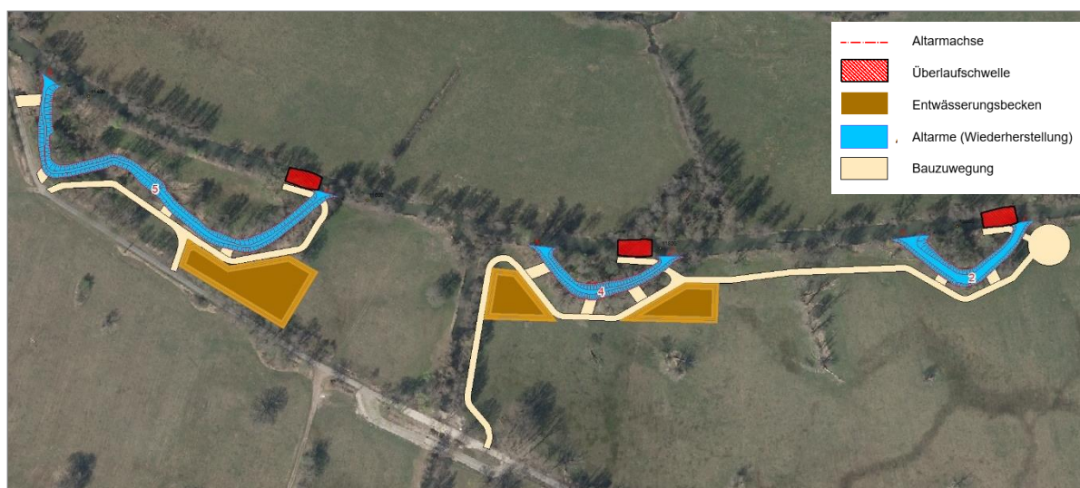
Abbildung 5.11: Bauzuwegungen und Entwässerungsbecken
