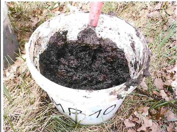
Herstellung der homogenisierten Mischprobe MP 10
