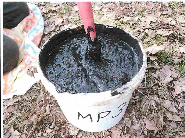
Herstellung der homogenisierten Mischprobe MP 3
