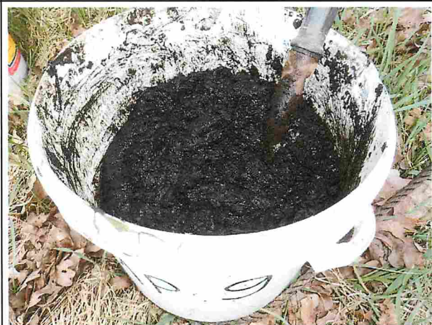
Herstellung der homogenisierten Mischprobe MP 9
