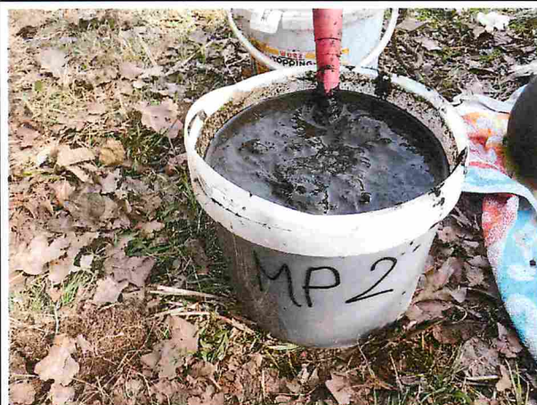
Herstellung der homogenisierten Mischprobe MP 2
