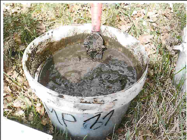
Herstellung der homogenisierten Mischprobe MP 11
