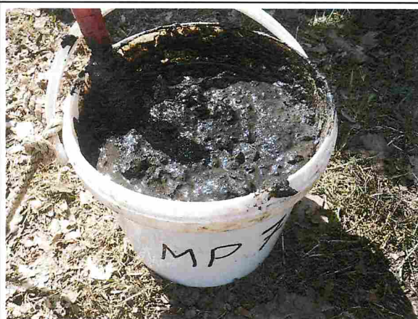
Herstellung der homogenisierten Mischprobe MP 7
