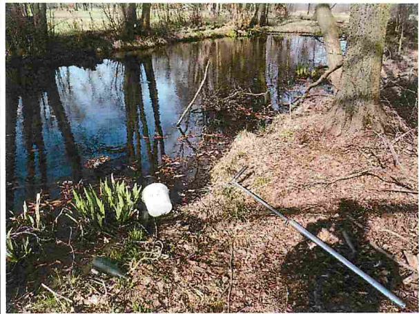
Auch in diesem Fließabschnitt erfolgte die Probenahme mittels Unterdruckschlickpumpe.
