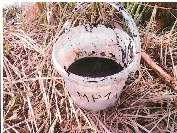
Herstellung der homogenisierten Mischprobe MP 1
