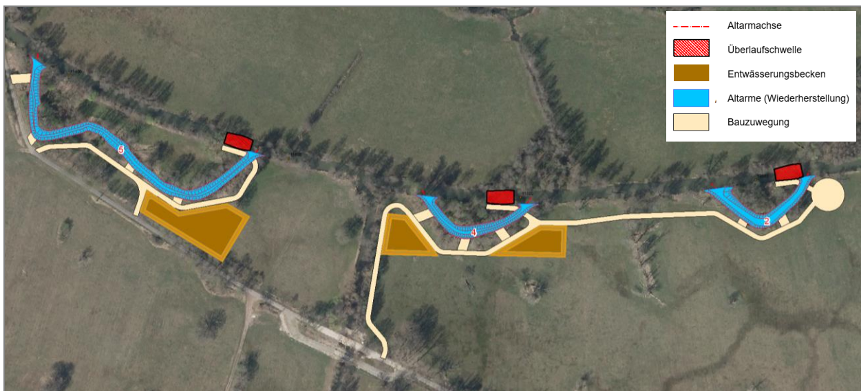
Abbildung 7.2: Bauzuwegungen und Entwässerungsbecken
