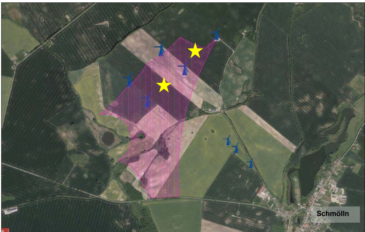
Abb. 1: Übersichtsplan mit den bestehenden WEA (blaue WEA) und den geplanten WEA (gelbe Sterne) im WEG Nr. 26 Schmölln (magentafarbene Schraffur) (EKS.BRANDENBURG.DE, 2018)
