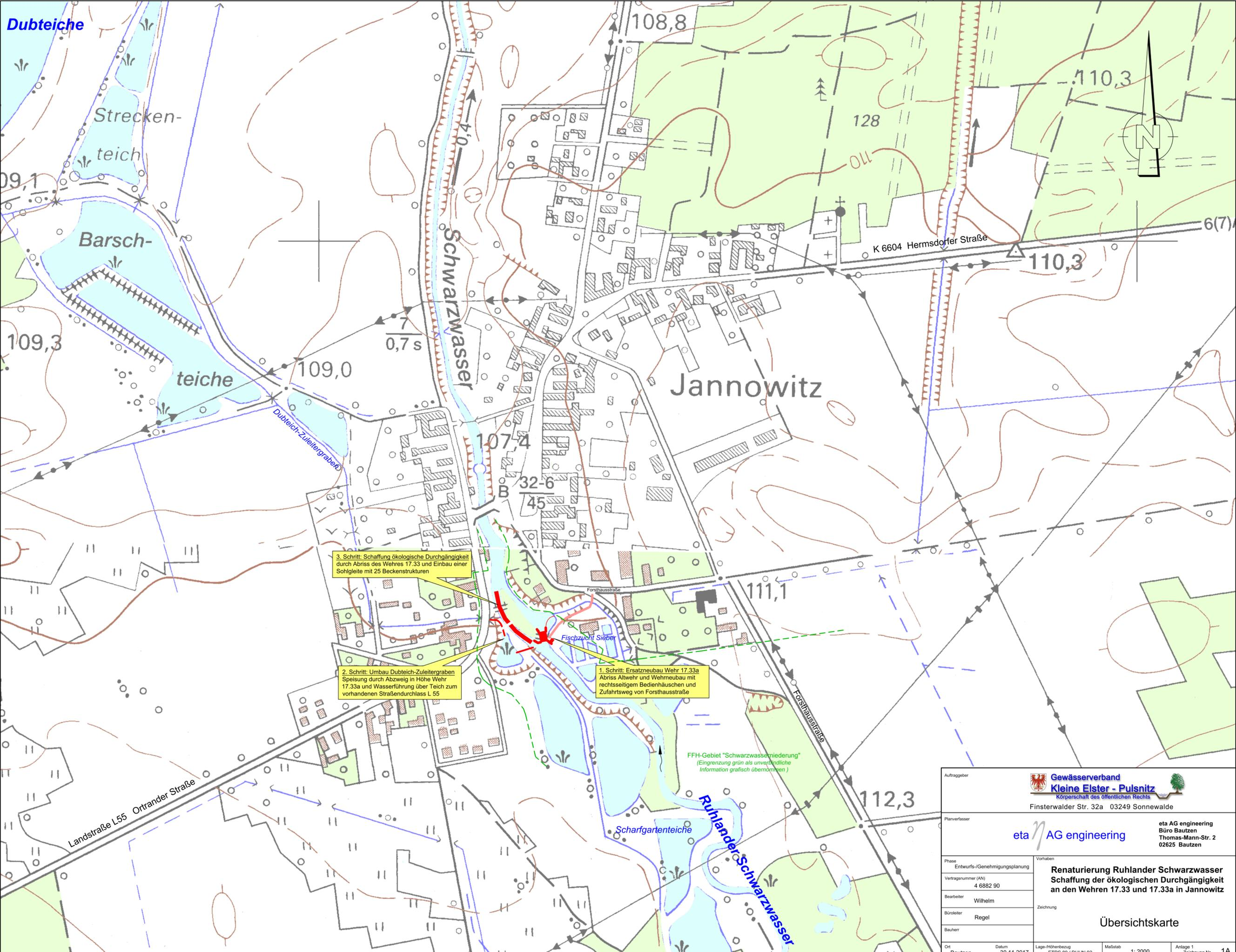
3. Schritt: Schaffung ökologische Durchgängigkeit durch Abriss des Wehres 17.33 und Einbau einer Sohlgleite mit 25 Beckenstrukturen
