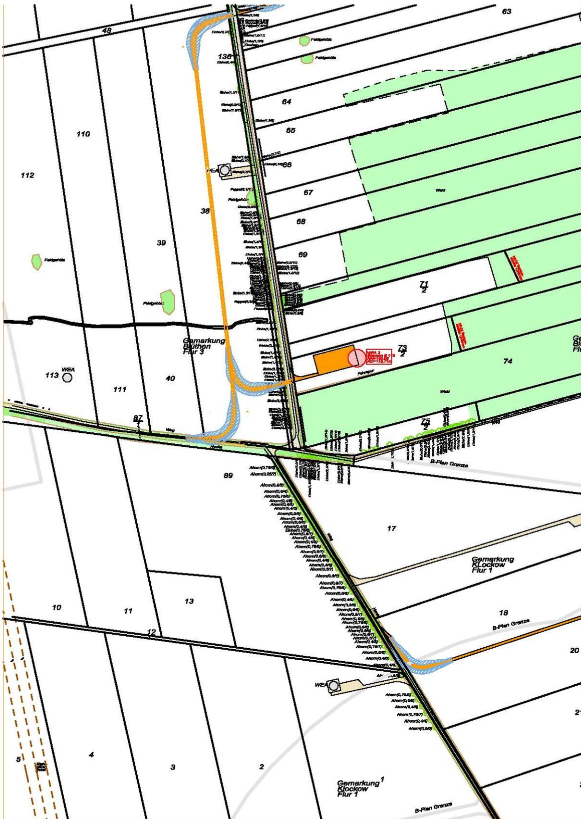
Abbildung 6 geplante Überschwenkbereiche (orange Schraffuren), welche mit mobilen Platten ausgelegt werden sollen
