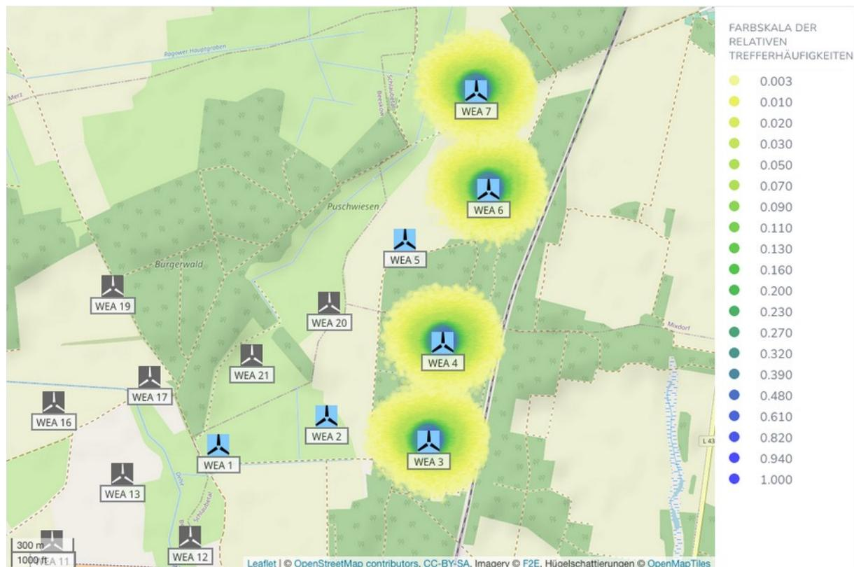
**Abbildung A.1.1:** Trefferhäufigkeiten von Eisstücken pro Rasterfläche (16m<sup>2</sup>) und Jahr in der Umgebung der WEA 3, 4, 6 und 7 am Standort Grunow-Mixdorf Erweiterung (Karte /1.4/).
