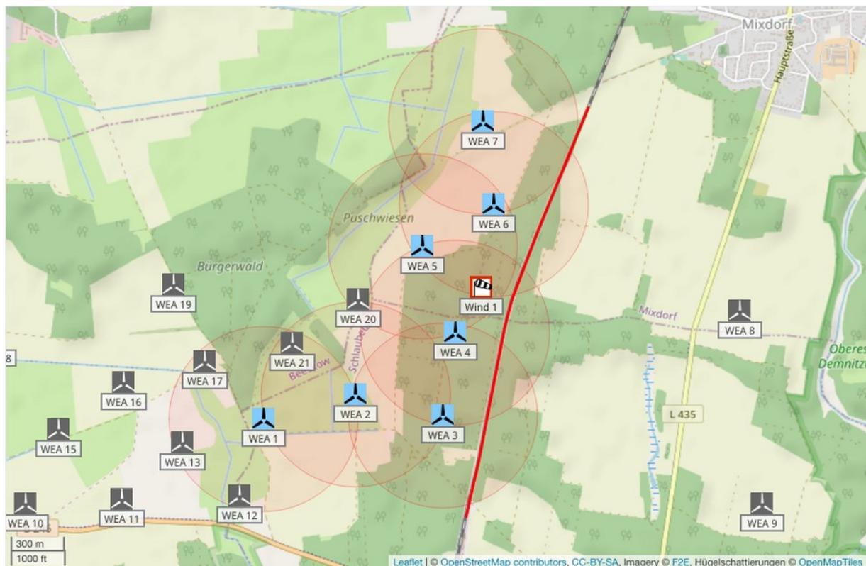
**Abbildung 4.3.1:** Potentielle Gefährdungsbereiche der WEA und Schutzobjekte am Standort Grunow-Mixdorf Erweiterung (Karte /1.4/).
