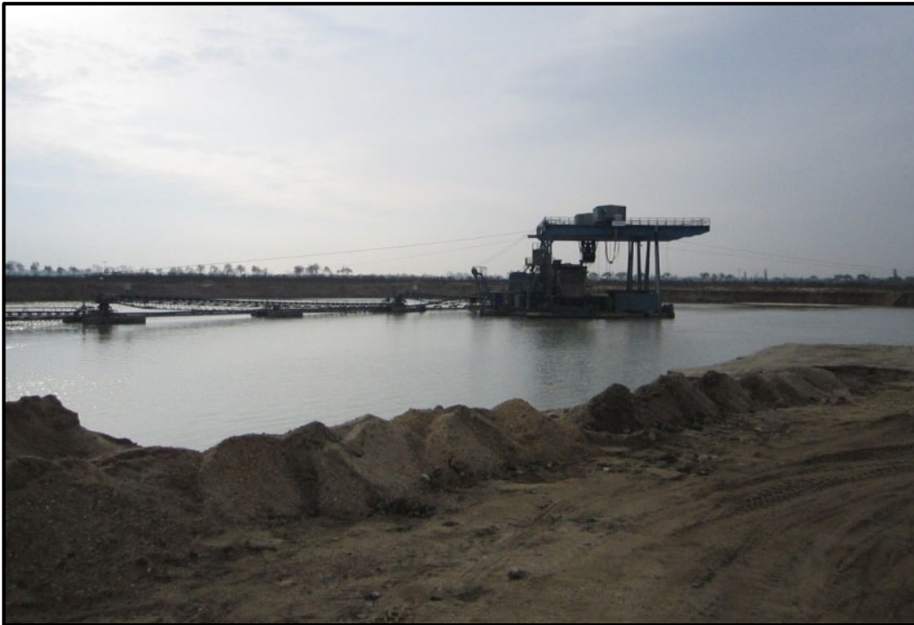
Abbildung 3: Geplante Gewinnungstechnologie - Nassbagger mit Schwimmbandanlage
