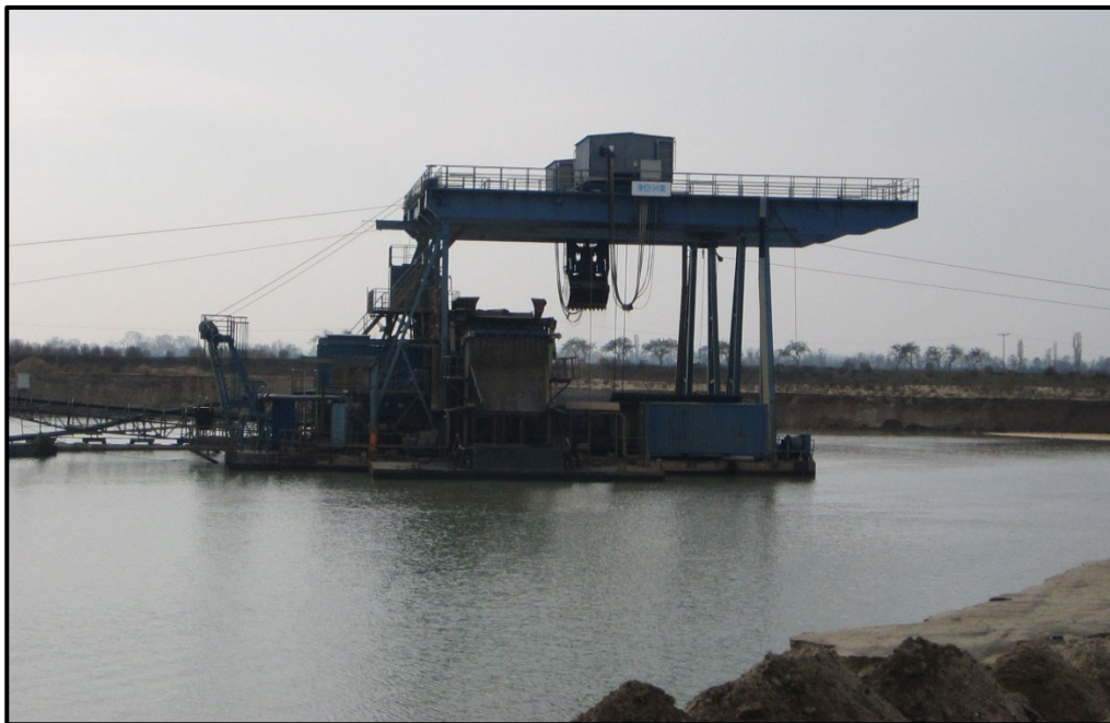
Abbildung 6 7: Geplantes Gewinnungsgerät RS 2x8,0/280 Bf (Fa. ROHR)
