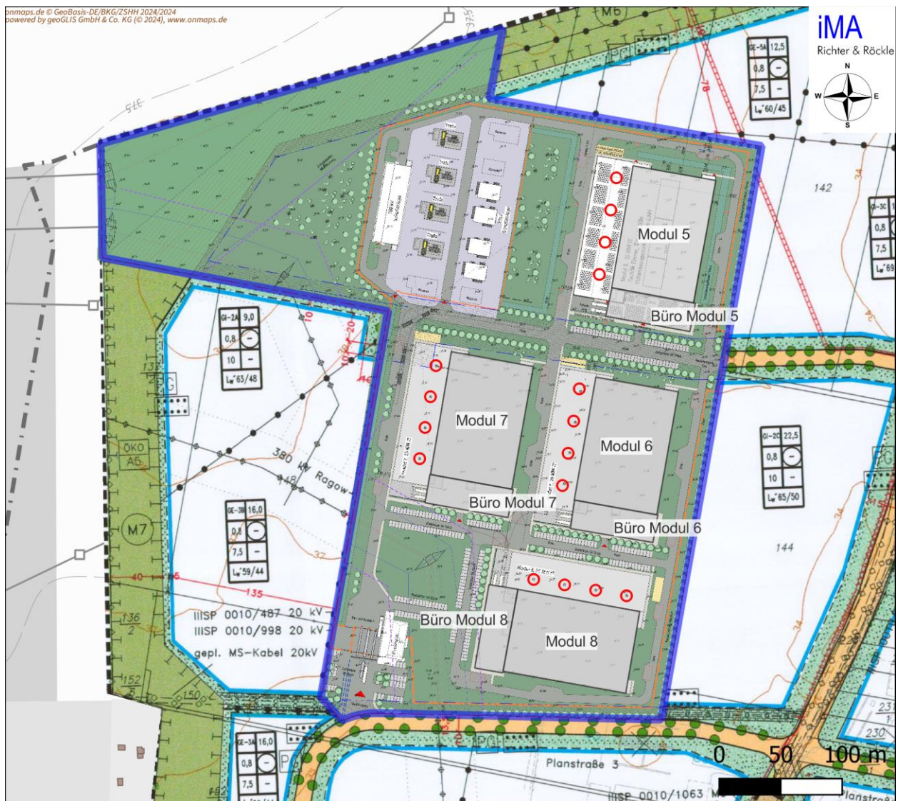
Abbildung 3-1: Lage der Modul-Gebäude und der Schornsteingruppen (rote Kreise) auf dem Betriebsgelände (blau umrandet). Kartengrundlage: onmaps.de (c) GeoBasis-DE/BKG/ZSHH 2024 und Lageplan Masterplan, Stand 15.04.2023.
