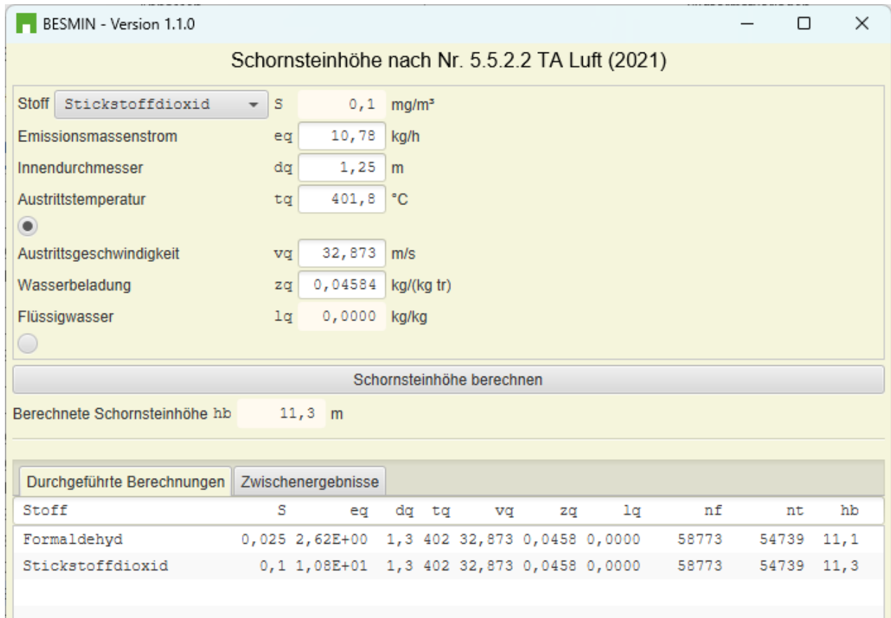
Abbildung A4-2: Bildschirmausgabe BESMIN für die 5er-Schornsteingruppen (4 Modul-Generatoren mit 100 % Last und Haus-Generator mit 100 % Last). S: S-Wert in mg/m 3 , hb: berechnete Schornsteinhöhe in m.
