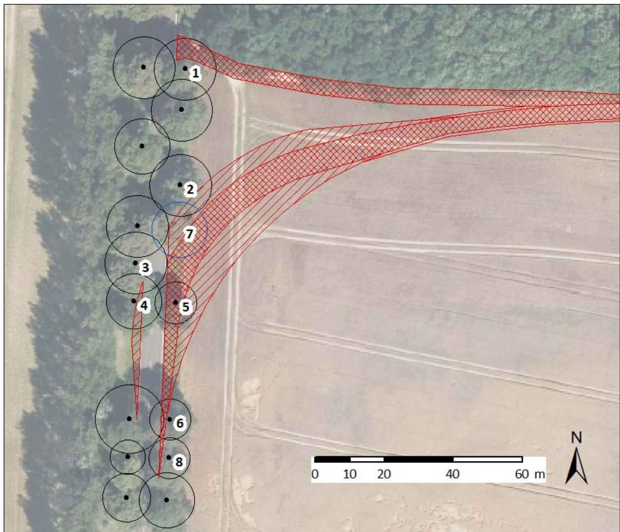
Abb. 12: Bestandsbäume im Bereich des Zuwegungstrichters
