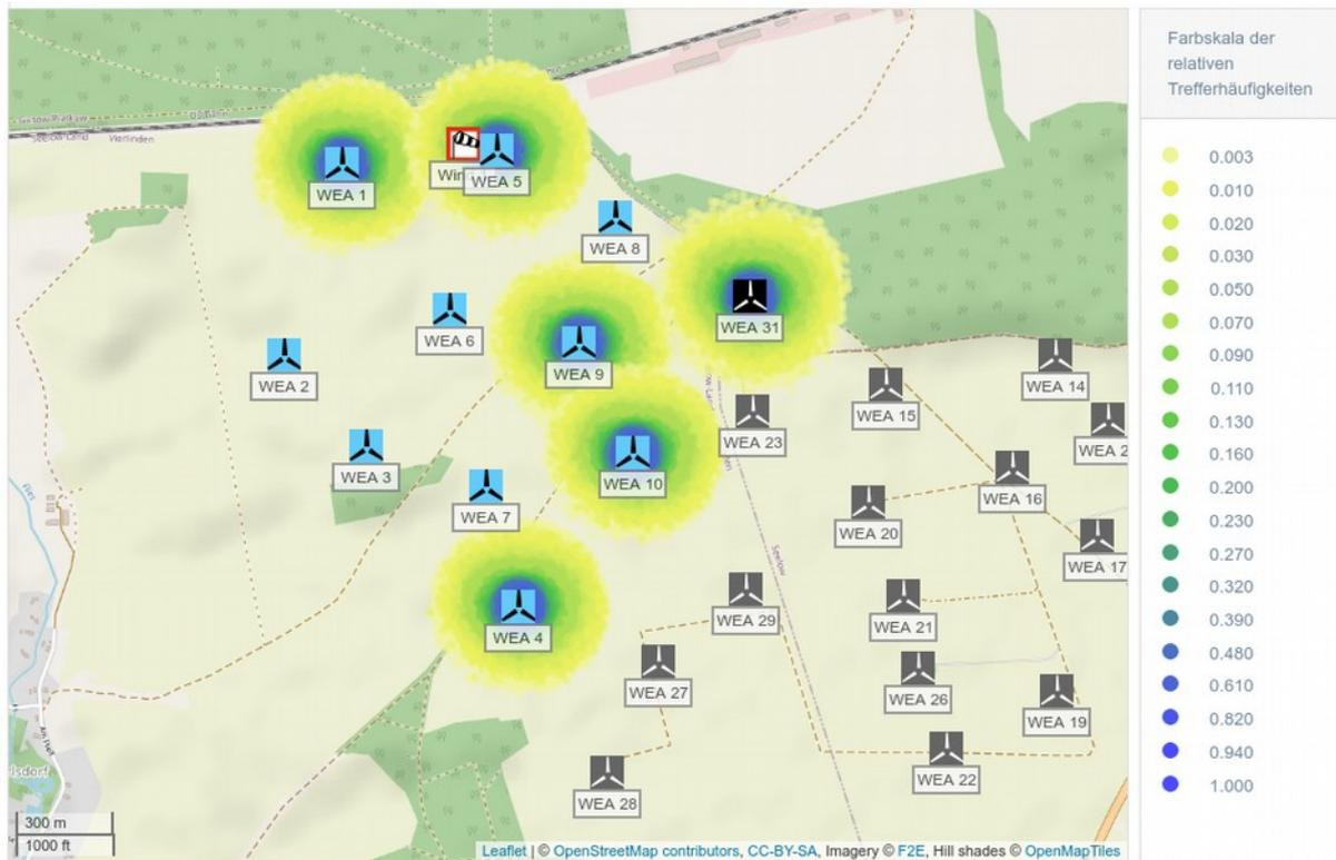
**Abbildung B.1.1:** Trefferhäufigkeiten von Eisstücken pro Rasterfläche (16m<sup>2</sup>) und Jahr in der Umgebung der WEA 1, 4, 5, 9, 10 und 31 am Standort Seelow Vierlinden (Karte 17/).
