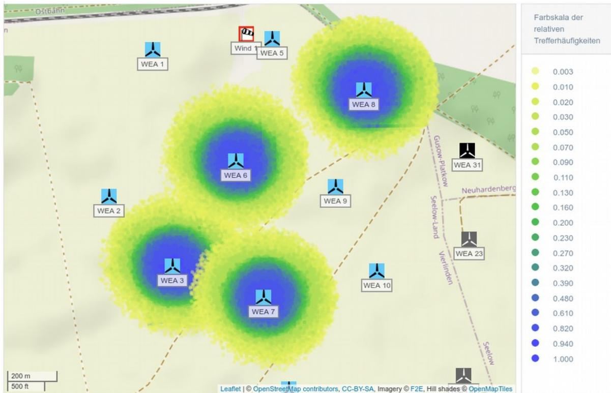
**Abbildung A.1.1:** Trefferhäufigkeiten von Eisstücken pro Rasterfläche (16m<sup>2</sup>) und Jahr in der Umgebung der WEA 3, 6, 7 und 8 am Standort Seelow Vierlinden (Karte 17/).
