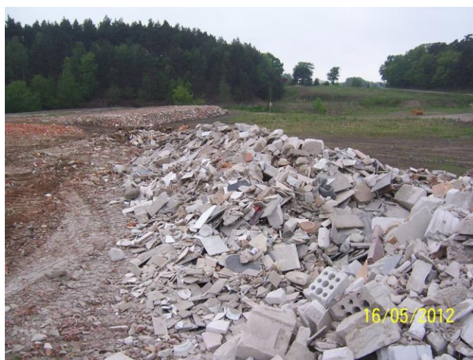
Abbildung 4: Zur Profilierung eingesetzte Gemische aus Beton, Ziegel, Fliesen und Keramik
